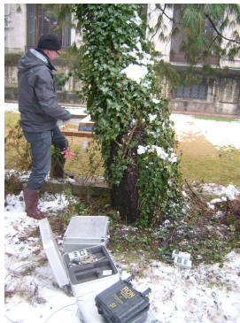
Bild Nr. 3: Durchführung einer statisch integrierten Messung (SIM)
