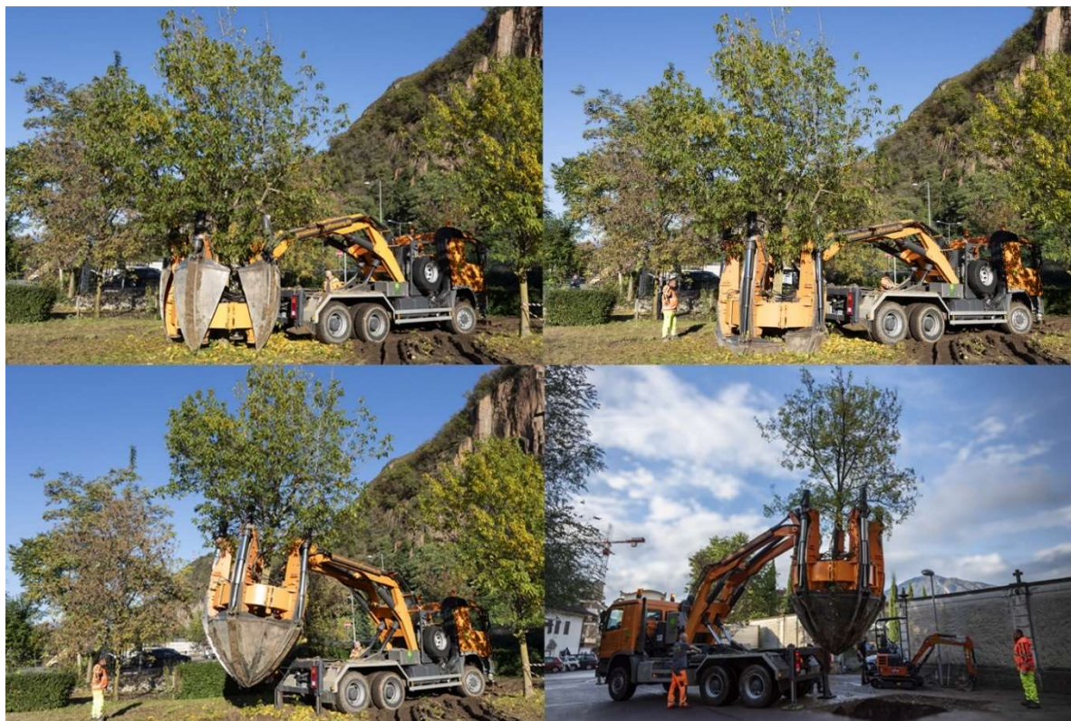
Baumverpflanzung mittels Ballenstechmaschine in der Sportzone Pfarrhof.
