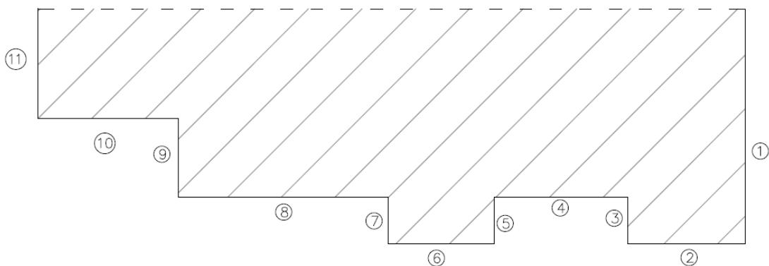
Flächenermittlung und Fassadennummerierung
