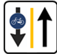
Figg. 29.8 Vertikale Beschilderung für Radfahrstreifen mit reservierter Fahrspur in Gegenrichtung zu anderen Fahrzeugen
