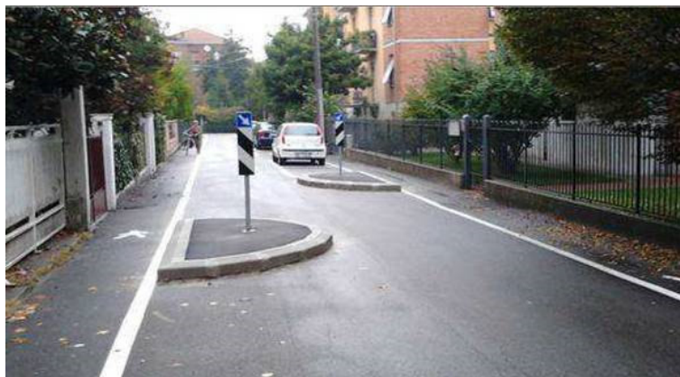
Abb. 26.6 Schikane durch alternierende Parkbuchten, geschützt durch erhöhte Elemente (Ausland)
