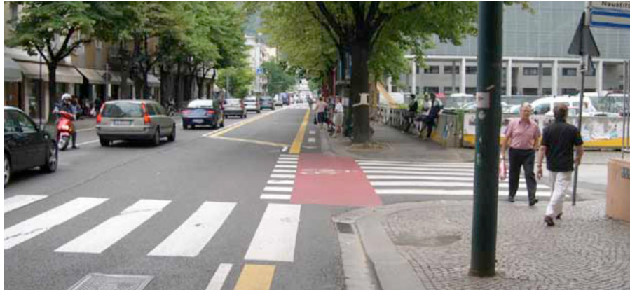
Abb. 23.1 - Beispiel für einen Radfahrstreifen (Breite 1 m) neben einer Bussonderfahrspur (3,5 m)
