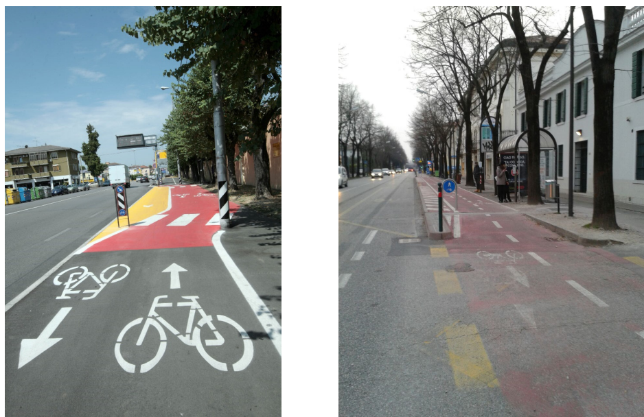
Figg. 24.2 - Beispiele für Überschneidungen zwischen Bushaltestellen und Radwegen
