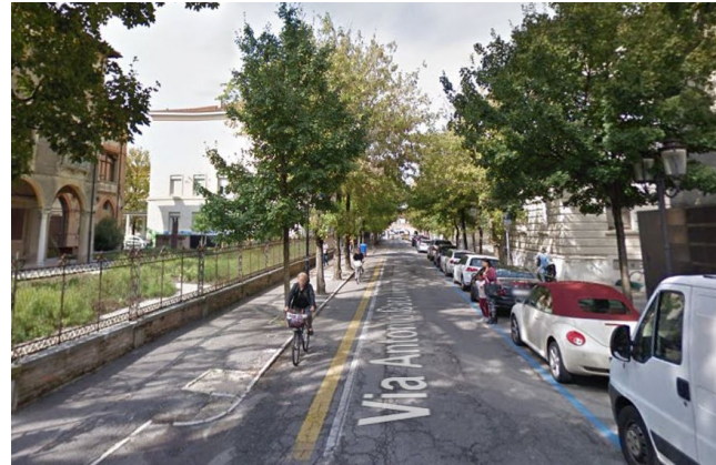
Figg. 29.9 Beispiele für einen Radweg mit reservierter Fahrspur in Gegenrichtung zu anderen Fahrzeugen
