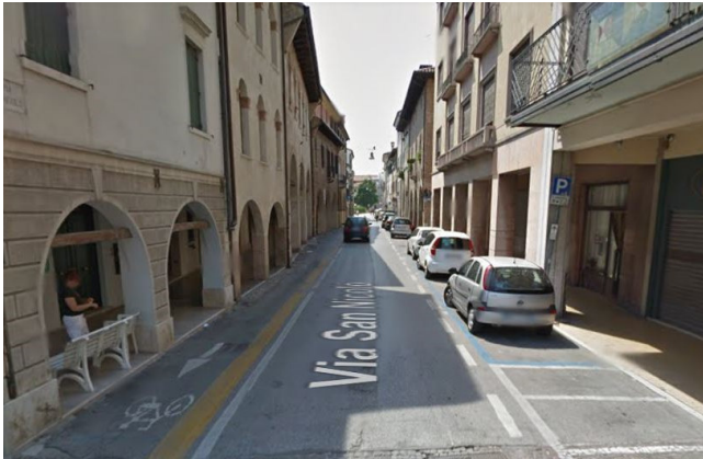
Figg. 29.9 Beispiele für einen Radweg mit reservierter Fahrspur in Gegenrichtung zu anderen Fahrzeugen
