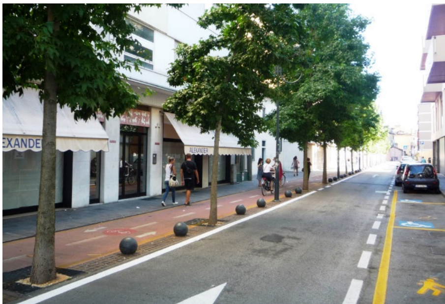
Abb. 29.5 Beispiel für einen eigenständigen Radweg, der durch eine Reihe von Bordsteinen und Bäumen getrennt ist
