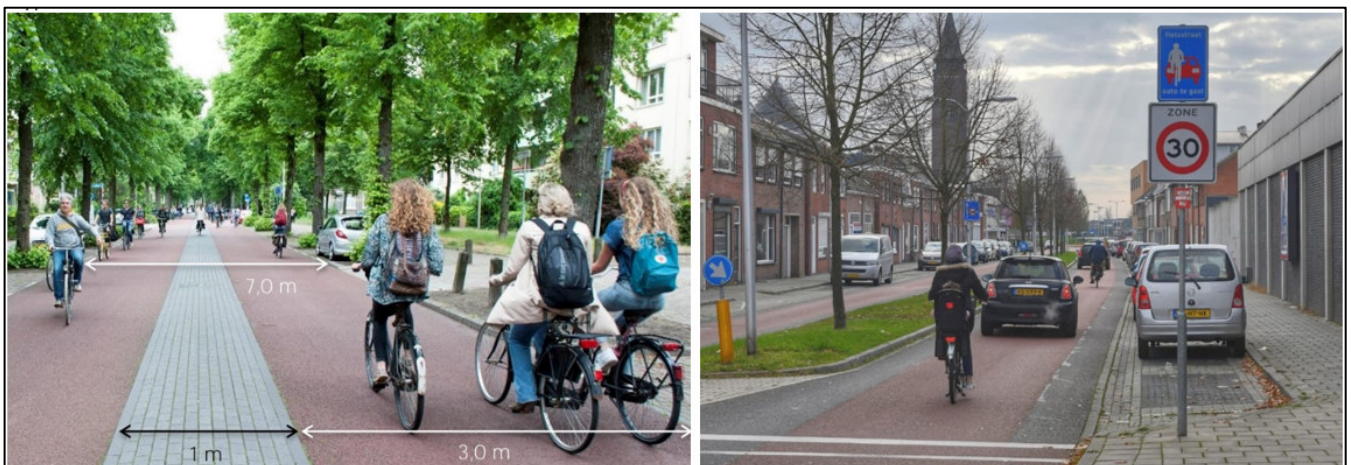
Abb. 29.15 Beispiele für die Gestaltung der Fahrbahn innerhalb einer Radzone (NL)
