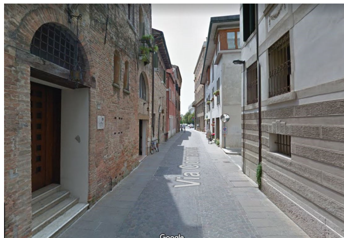
Abb. 27.1 Beispiel für die Verwendung unterschiedlicher Bodenbeläge in einer ZTL zur Kennzeichnung von Fußgängerbereichen ohne Beschilderung (Treviso, Via Roggia)
