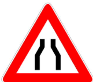
Abb. 26.12 Senkrechte Schilder für Engstellen und Engstellen mit wechselnder Einbahnrichtung
