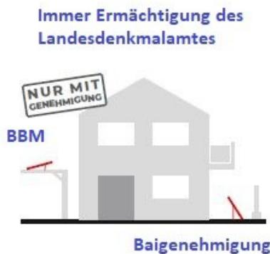
5) In den **Zonen für öffentliche Einrichtungen** dürfen Photovoltaikpaneele und thermische Sonnenkollektoren auch auf freien Flächen installiert werden. Für die Installierung muss ein Antrag um Ausstellung einer **Baugenehmigung** eingereicht werden.
